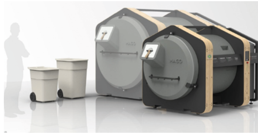
Een vernieuwende manier om energie op te wekken, is het opwaarderen van lokaal maa- en keukenafval tot compost in ronddraaiende trommels: moderne biomeilers. Daarbij komt duurzame warmte vrij voor warm tapwater of verwarming. Verder levert het een kostenbesparing op, omdat het afval/maaisel niet opgehaald en verwerkt hoeft te worden. Foto: DYNTEQ
